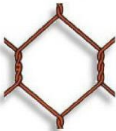
Exemple de maille en double torsion
